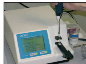
L'uso di un osmometro pressurizzato permette di correggere la pressione osmotica di tutti i diluitori
